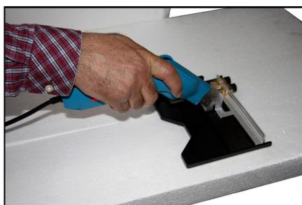
Taglio sagomato del pannello isolante mediante: cutter termico art. KD-5H, guida regolabile art. K-SLED, lama sagomata art. KD-G.
