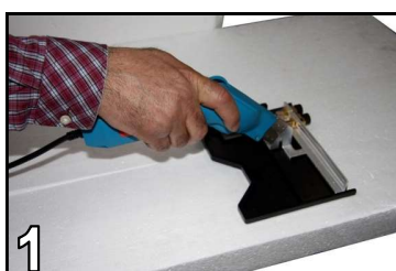
1 Taglio sagomato del pannello isolante mediante: cutter termico art. FIX-5H250W, guida regolabile art. K-SLED, lama sagomata art. KD-G.
