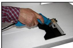
Taglio sagomato del pannello isolante mediante: cutter termico art. FIX-5H, guida regolabile art. K-SLED, lama sagomata art. KD-G.
